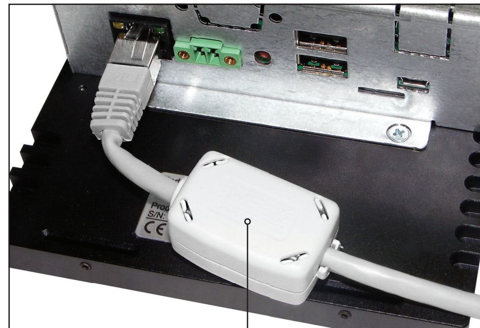
Nucleo di ferrite apribile fornito in dotazione
